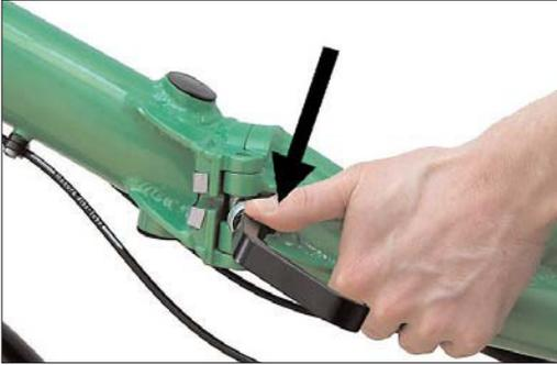
Nach dem Öffnen des Schnellspanners am Faltgelenk muss der Schnellspanner nach unten gedrückt werden, damit der Sicherungsbolzen ausrastet.
