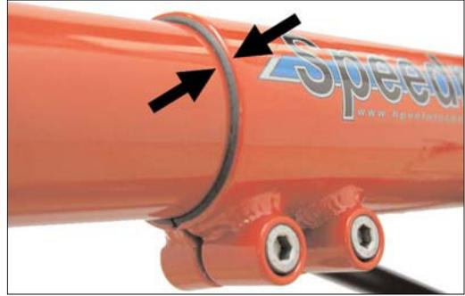
Zwischen Haupttrahmen und Tretlagerausleger muss die Distanzbuchse von vorne sichtbar sein.
