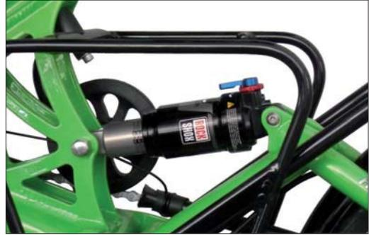
*Federelement ROCKSHOX MONARCH. Die Einstellung der Dämpfung erfolgt über das rote Rad am hinteren Ende. Das Federelement muss so eingebaut sein, dass der Drehhebel zur Blockierung am hinteren Ende nach oben zeigt.*
