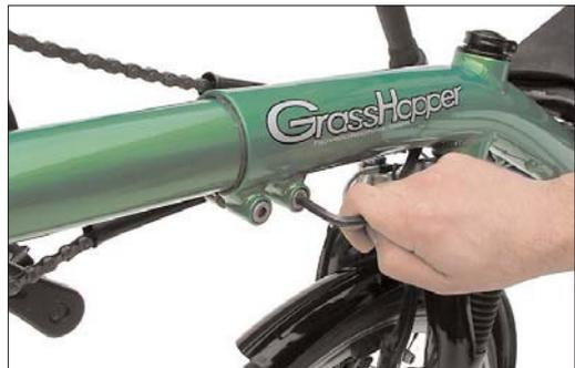
Lösen der Klemmschrauben zum Verstellen des Tretlagerauslegers.
