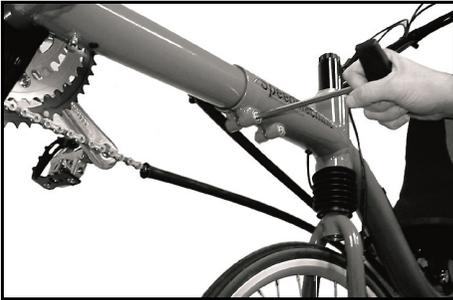
Lösen der Klemmschrauben zum Verstellen des Tretlagerauslegers.
