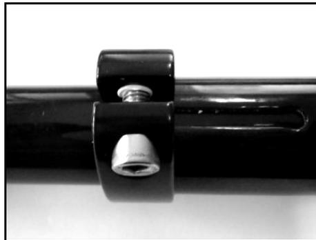
*Klemmung der Höhenverstellung am Obenlenkervorbau. Beim Blick auf den Klemmschlitz darf das Rohrende der oberen Vorbauhälfte nicht sichtbar sein*
