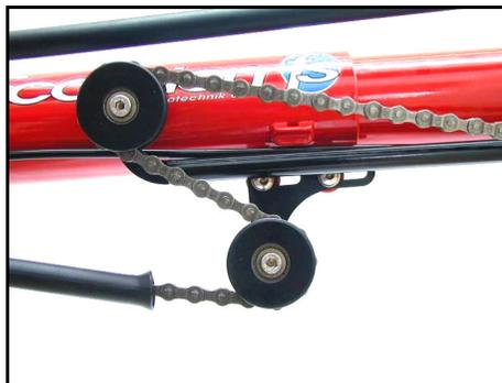
*Verlauf der Kette bei Rahmenschnellverstellung über die Umlenkrollen*
