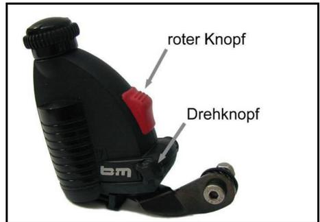
*Der Seitenläuferdynamo wird durch Drücken auf den roten Knopf eingeschaltet. Zum Ausschalten wird er vom Rad weggeschwenkt.*
