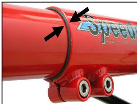
Zwischen dem Hauptrahmen und dem Tretlagerausleger muss die Distanzbuchse sichtbar sein.
