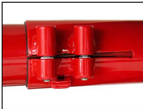
Beim Blick von unten in den Klemmschlitz darf das Ende des Tretlagerauslegers nicht sichtbar sein.
