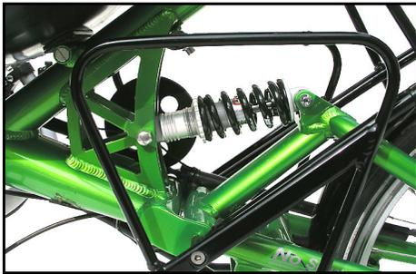
Federelement mit Stahlfeder. Durch Drehen des Einstellrings am vom vorderen Ende der Stahlfeder stellen Sie die Federvorspannung ein
